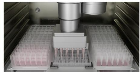
检测板上的每个检测室都有新培养基注入口、微量样品检测室和废液移出口。
